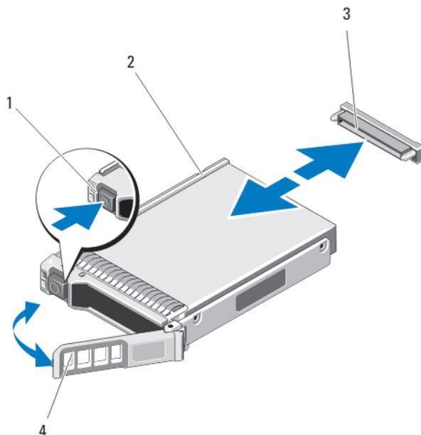
**Ilustración 19. Extracción e instalación de una unidad de disco duro/SSD**
