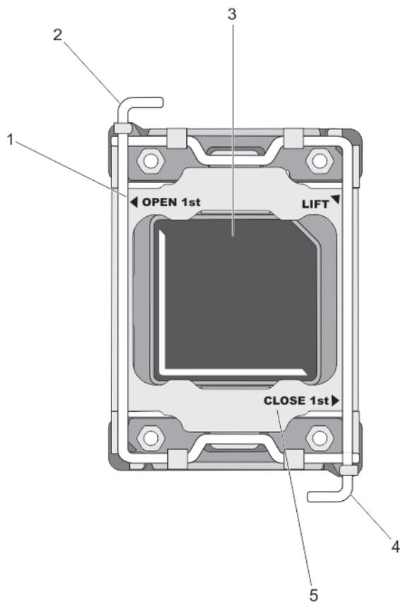
**Ilustración 17. Secuencia de apertura y cierre de la palanca del protector del procesador**
