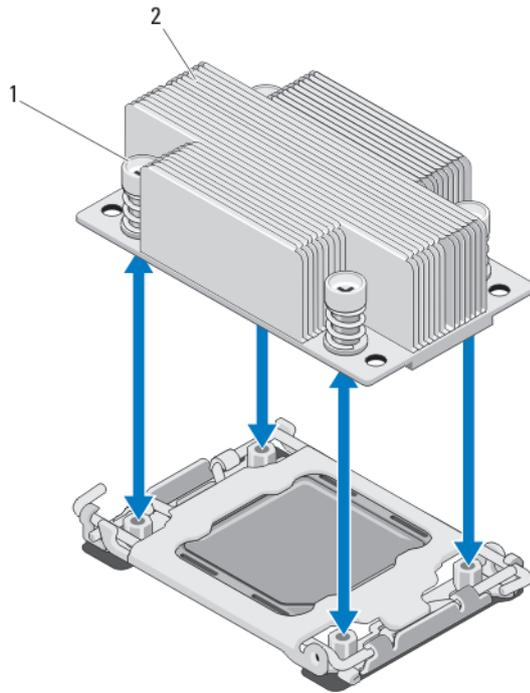
**Ilustración 16. Instalación y extracción de un disipador de calor**
