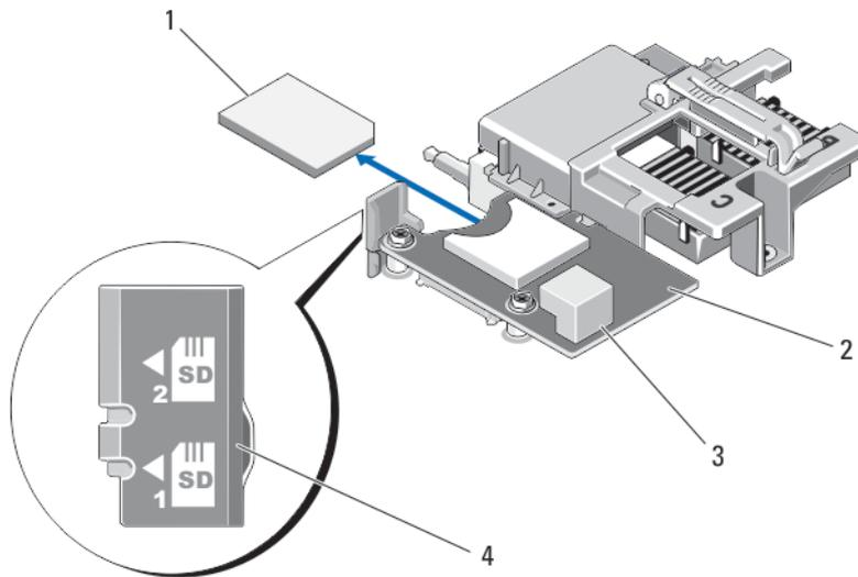
**Ilustración 12. Sustitución de la tarjeta SD**
