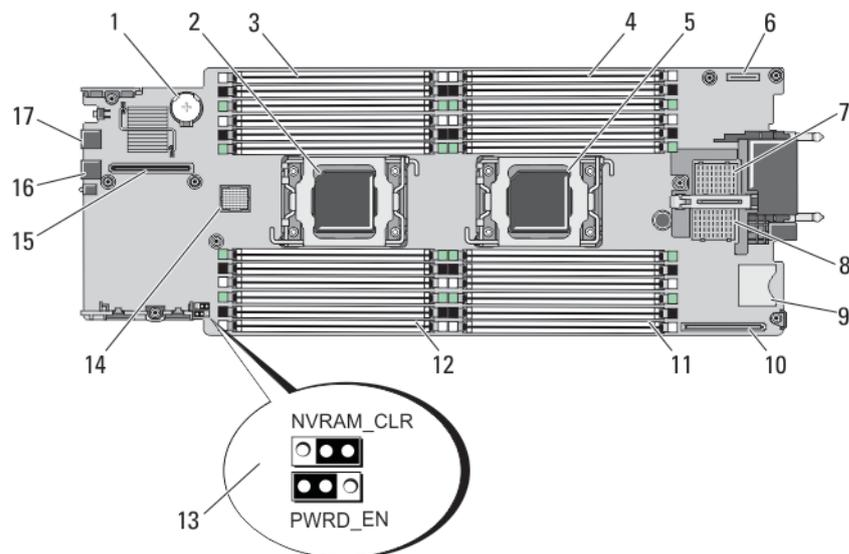
Ilustración 25. Conectores de la placa base
