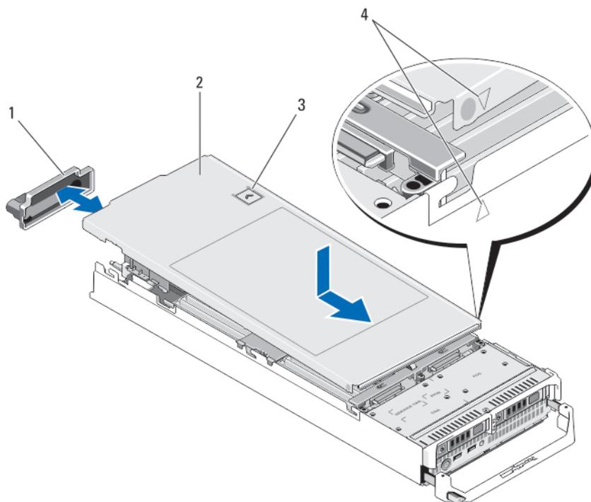
**Ilustración 6. Apertura y cierre del módulo de servidor**
