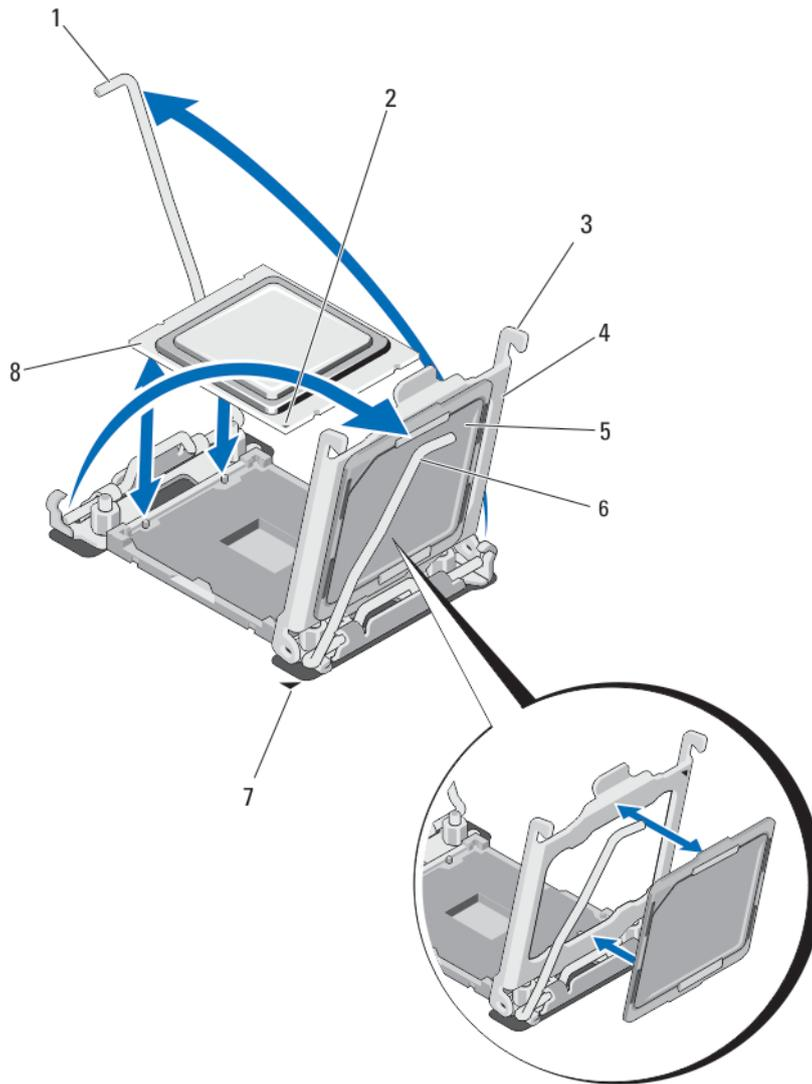
**Ilustración 18. Instalación y extracción de un procesador**
