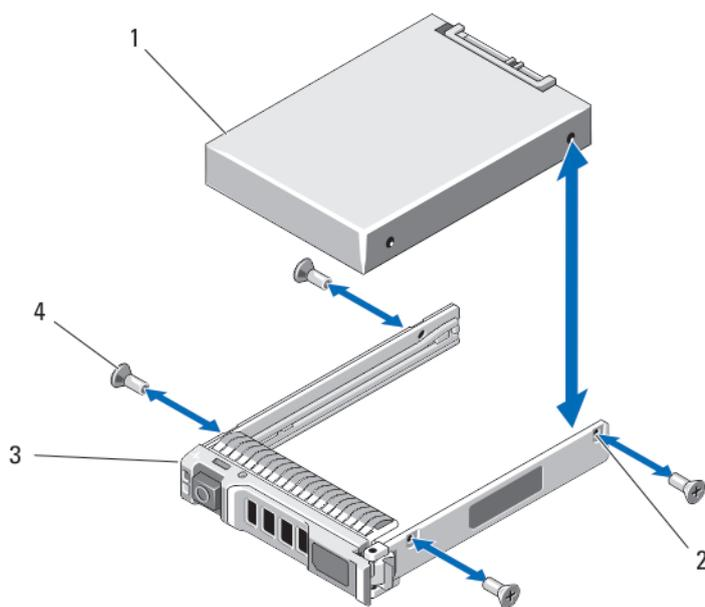
Ilustración 20. Extracción e instalación de una unidad de disco duro/SSD en un portauidades de disco duro/SSD
