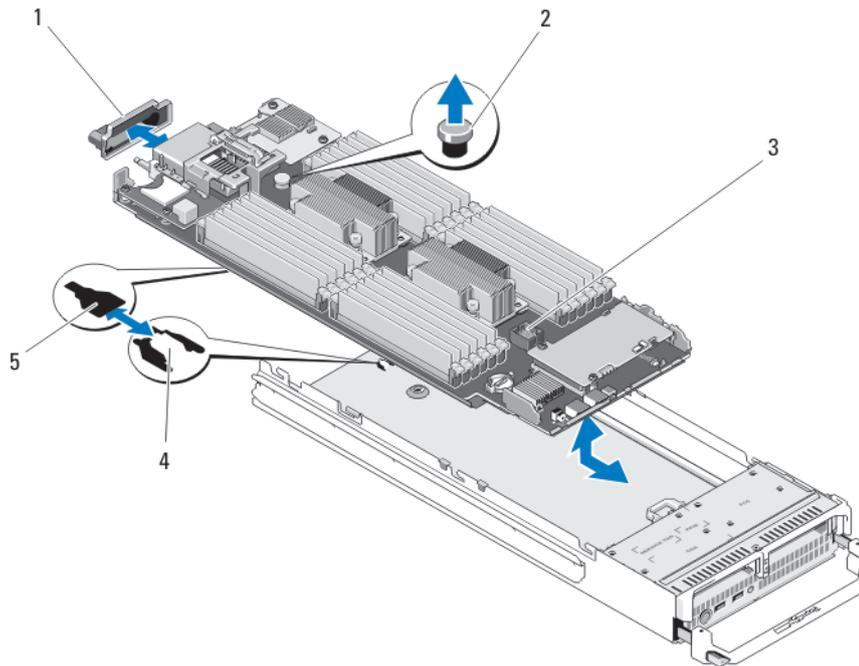
**Ilustración 22. Extracción e instalación de la placa base**
