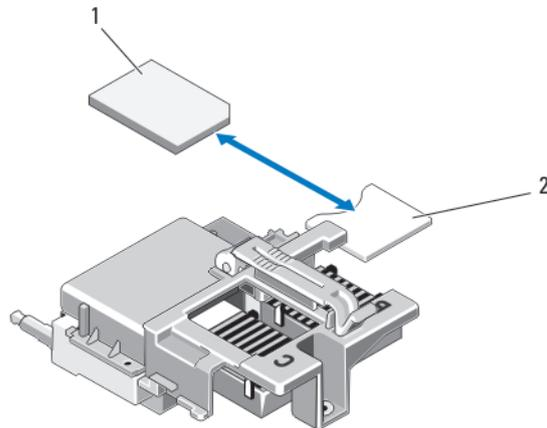
**Ilustración 14. Sustitución de la tarjeta vFlash SD**
