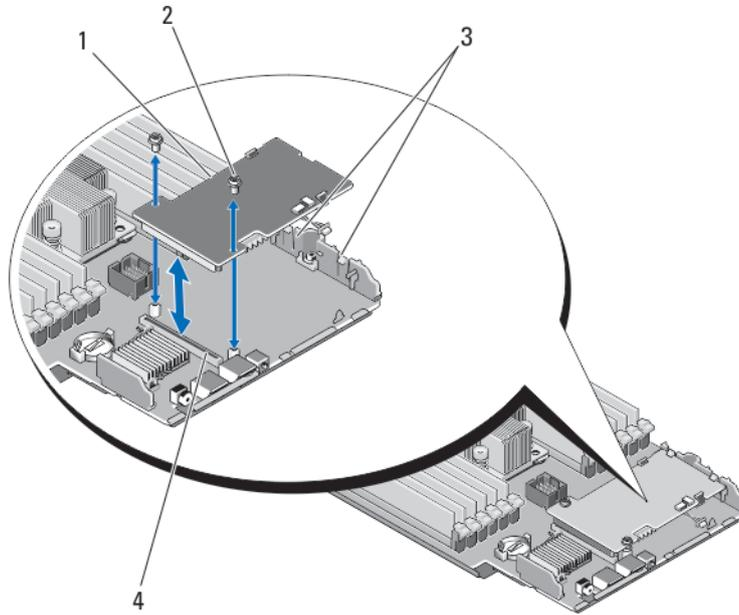
**Ilustración 24. Extracción y colocación de la tarjeta controladora de almacenamiento**
