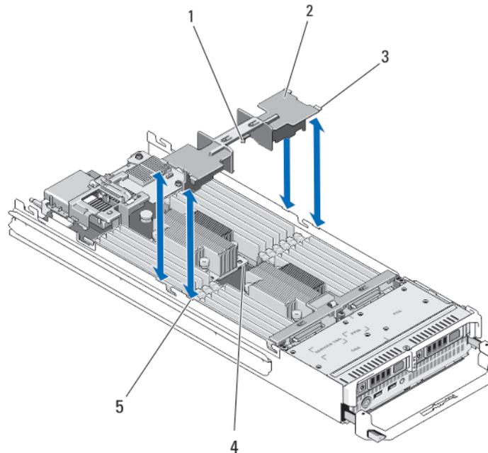
**Ilustración 8. Instalación y extracción de la funda de enfriamiento**
