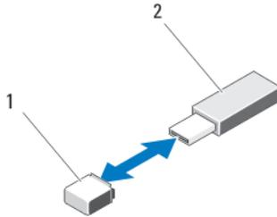
Ilustración 13. Sustitución de la memoria USB
