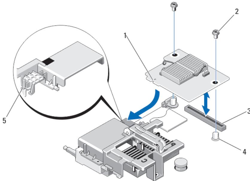
**Ilustración 15. Extracción e instalación de la tarjeta de red secundaria/tarjeta vertical de LOM**
